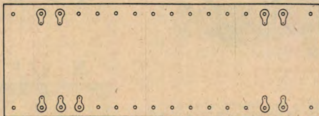
4. ábra. A szerelőlap lyuggalási terve (170×60×2, furatok Ø 3 mm) a 14 forrasztófül felszegecselésére. — Készül 2 db. Jobboldalon a szerelőtartó lába (70+1
